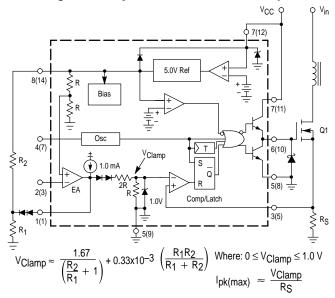
Figure 20. Soft-Start Circuit
