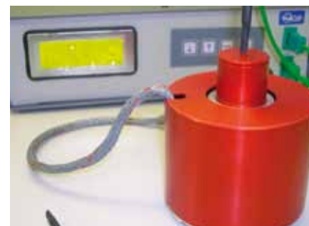
Vue de l'appareil avec le doigt placé dans le fourreau chauffant.
