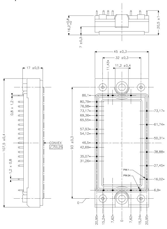
ALL DIMENSIONS MARKED "  $^*$  " ARE TOLERENCED AS :  $\bigcirc$   $\bigcirc$  0,4
